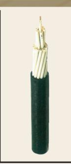
□ 600 / 1000 V-AUXILIARY CABLES (CONTROL CABLES) COPPER CONDUCTOR PVC INSULATED PVC SHEATHED CABLES
