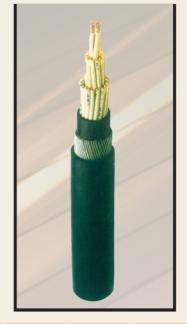
□ 600 / 1000 V-AUXILIARY CABLES (CONTROL CABLES) COPPER CONDUCTOR XLPE INSULATED STEEL WIRE ARMOURED
